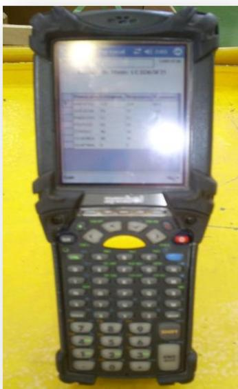
**Figura 5. Coletor RF. Fonte: Schneider Electric Brasil Ltda.**
