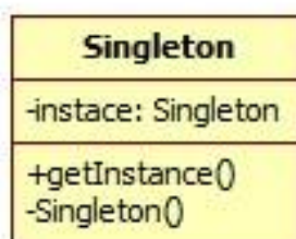
Figura 2: Padrão de Projeto Singleton Fonte: Elaborada com os dados da própria pesquisa
