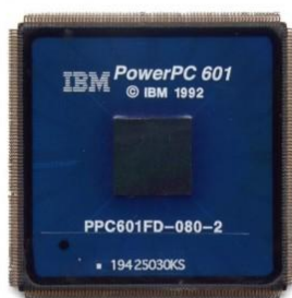
Figura 3: Processador de um power PC IBM com arquitetura RISC Fonte: http://publib.boulder.ibm.com/infocenter/
